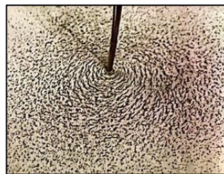
รูป 15.10 แนวการเรียงตัวของผงเหล็กรอบลวดตัวนำเส้นตรงที่มีกระแสไฟฟ้าผ่าน
