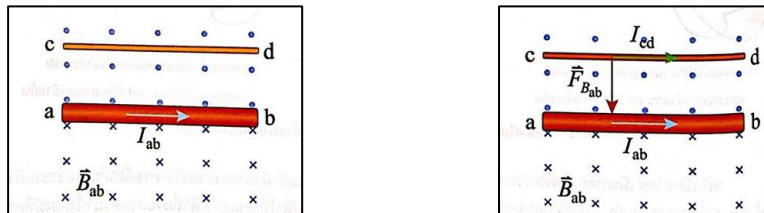
ก. สนามแม่เหล็ก \vec{B}_{ab} รอบขดลวดตัวนำส่วน ab ข. แรงแม่เหล็กที่กระทำต่อลวดตัวนำส่วน cd รูป 15.34 แรงแม่เหล็กเนื่องจากสนามแม่เหล็กของขดลวดตัวนำส่วน ab ที่กระทำต่อลวดตัวนำส่วน cd
