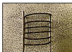
รูป 15.16 การเรียงตัวของผงเหล็กเมื่อมีกระแสไฟฟ้าผ่านโซเลนอยด์
