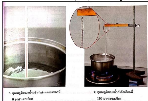
รูป 16.4 การวัดอุณหภูมิขณะที่น้ำแข็งกำลังหลอมเหลวและน้ำกำลังเดือด
