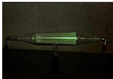
รูป 15.22 แนวการเคลื่อนที่ของอิเล็กตรอนระหว่างขั้วแคโทดและขั้วแอโนด
