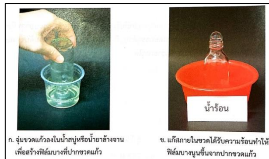
รูป 16.10 การเปลี่ยนแปลงความดันของแก๊สเมื่อได้รับความร้อน
