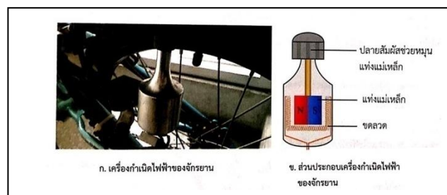
รูป 15.60 ตัวอย่างเครื่องกำเนิดไฟฟ้ากระแสสลับ
