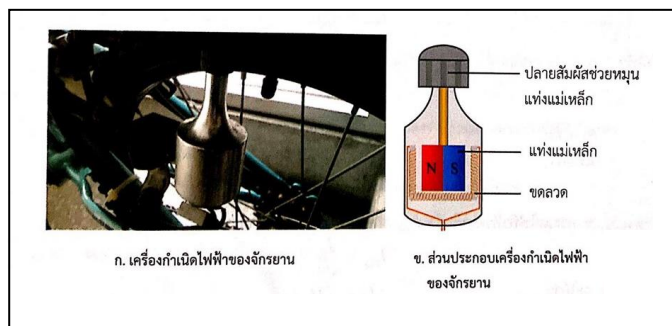
รูป 15.60 ตัวอย่างเครื่องกำเนิดไฟฟ้ากระแสสลับ
