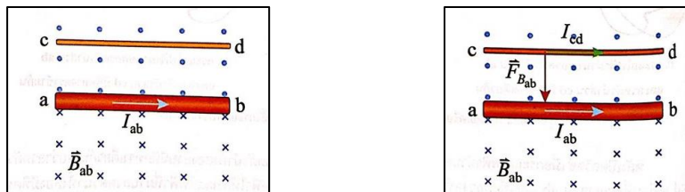
ก. สนามแม่เหล็ก \vec{B}_{ab} รอบขดลวดตัวนำส่วน ab ข. แรงแม่เหล็กที่กระทำต่อลวดตัวนำส่วน cd รูป 15.34 แรงแม่เหล็กเนื่องจากสนามแม่เหล็กของขดลวดตัวนำส่วน ab ที่กระทำต่อลวดตัวนำส่วน cd
