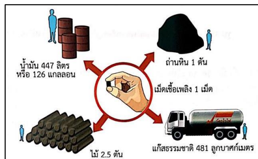
รูป 3.10 เม็ดเชื้อเพลิงนิวเคลียร์ที่มีส่วนผสมของยูเรเนียม-235 ขนาดประมาณเท่าข้อนิ้วก้อย สามารถให้พลังงานเทียบเท่ากับการเผาไหม้น้ำมัน 447 ลิตร หรือ ถ่านหิน 1 ตัน หรือ แก๊สธรรมชาติ 481 ลูกบาศก์เมตร หรือ ไม้ 2.5 ตัน
