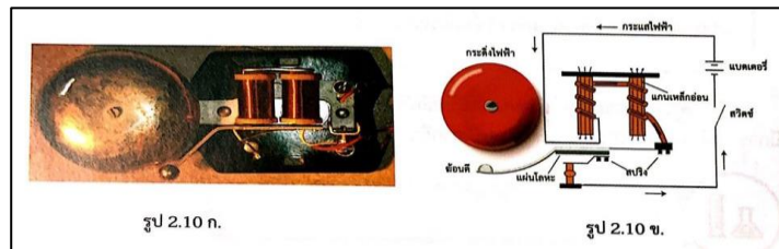
รูป 2.10 ก. กระแสไฟฟ้า ข. ส่วนประกอบของกระดิ่งไฟฟ้า
