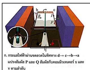
รูป 15.44 แรงกระทำต่อขดลวดของมอเตอร์ไฟฟ้ากระแสตรง
