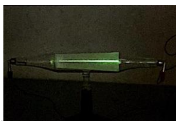
รูป 15.22 แนวการเคลื่อนที่ของอิเล็กตรอนระหว่างขั้วแคโทดและขั้วแอโนด
