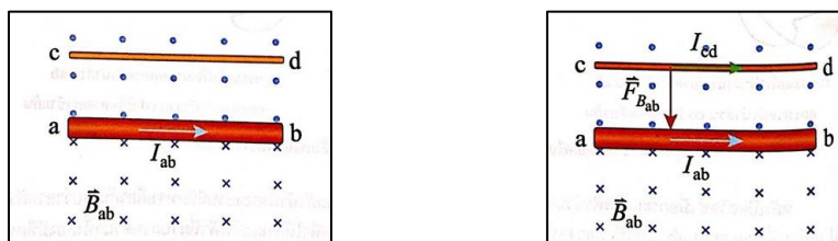
ก. สนามแม่เหล็ก \vec{B}_{ab} รอบลวดตัวนำส่วน ab ข. แรงแม่เหล็กที่กระทำต่อลวดตัวนำส่วน cd รูป 15.34 แรงแม่เหล็กเนื่องจากสนามแม่เหล็กของลวดตัวนำส่วน ab ที่กระทำต่อลวดตัวนำส่วน cd
