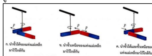
รูป 15.2 แรงระหว่างขั้วแม่เหล็ก
