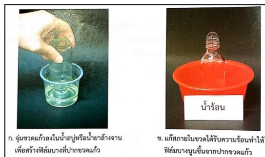
รูป 16.10 การเปลี่ยนแปลงความดันของแก๊สเมื่อได้รับความร้อน
